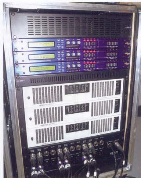
Amplification Adamson : les fameux PLM Lab.Gruppen pilotés par les XTA en réseau
